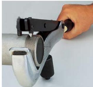
ネススリーでは、片方の刃を反対方向に付け替えて、短いパイプねじ等も修理できます。
