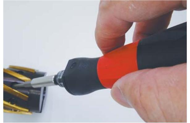
●スピーディEインダストリアルの赤いプラスチック部を右又は左に回すことにより、電動によりねじ締め及びねじ開けをします。0.4Nmまでのトルクコントロールが効いていますので、それ以上は手の力でねじ締めをします。ねじを開ける場合も同様に、手の力でねじを開けてから、電動を利用します。
