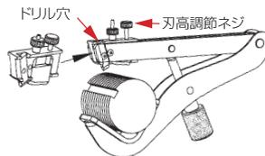
※ネススリーのブレード2本を取りはずし、ブレード1本をスキップアクセサリに挿入してから、ネススリーに取り付けます。
