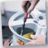
一定の範囲内で、トルクを連続的に設定できます。ハンドル部の小窓内に設定トルクの数字が表示されますので、トルクセッターを利用して容易に必要なトルク値を設定できます。(設定トルクの目盛は、ハンドルによって異なります。) EN ISO 6798、BS EN26789、ASME B107.14Mの基準によって検査されています。精度は±6%以内。(0.1〜0.6Nmのハンドルは±10%以内。)締め付けトルクが達成されると、クリック音がして、ドライバー内部のブレードが滑ります。手に滑りにくいピーハ・ソフトフィニッシュ®グリップ。トルク範囲によってハンドルサイズが異なります。
