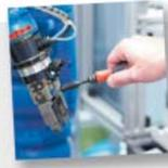
ピーハ社にて予めトルク値を設定済の固定トルクドライバー。EN ISO 6798、BS EN 26789、ASME B107.14Mによって検査されています。精度は±6%以内。締め付けトルクが達成されると、クリック音で感知できます。ハンドル部は、手に滑りにくいピーハ・ソフトフィニッシュ®グリップ。トルク範囲によってハンドルサイズが異なります。
