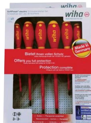
ピーハ・ソフトフィニッシュ®ハンドルのマイナスとプラスの6本組絶縁ドライバーセット。IEC 60900:2004に従い、AC1000Vまで絶縁。製品は各々テストされています。絶縁材はブレードに直接成形されています。高級クロームバナジウムモリブデン鋼製。焼入れ、黒染め仕上げ。
