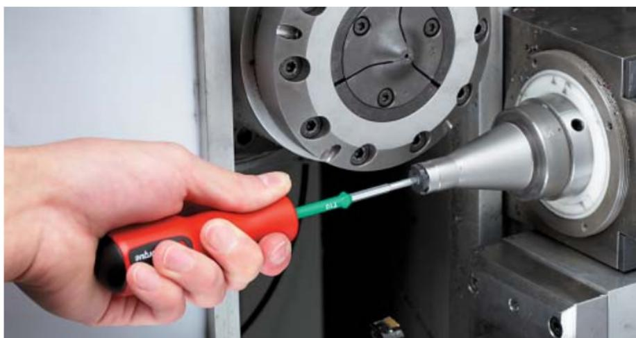
イージートルクの使用で超硬チップの装填が安全で容易になります
