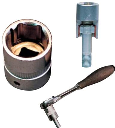
●ソケット内部にはめ込んだリテーナーリングの動きで、六角ボルト・ナットを保持できる画期的なソケット。狭い場所での六角ねじの挿入・取り出しが容易に行えます。
