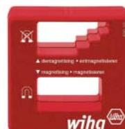
ドライバーやピンセット等の鉄製の工具の磁化及び脱磁に使用できます。ボックスは、衝撃に強い高級プラスチック製。サイズは、52(W)×29(D)×50(H)mm。工具を磁化するには、+マークの穴の中に工具を通します。工具を脱磁するには、-マークの穴の中をすべさせます。脱磁が完全でない場合は、もう一度、繰り返します。
