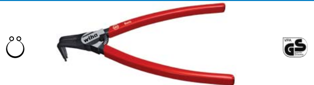
Z 3401 DIN ISO5254に従った90°角の軸用スナッピングプライヤー。先端は円筒状に精密に鍛造されています。クロームバナジウム工具鋼製。車軸にスナッピングを取り付けたり、取りはずすための工具です。
