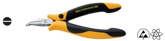
**Z 36 04** DIN ISO9655に従ったESD精密先曲りニードルノーズプライヤー。先曲り角度、約45°、抓み部はギザ付。C45特殊工具鋼製。焼入れ、焼戻し処理をしています。精密部品を掴んだり、曲げたりするのに使います。
