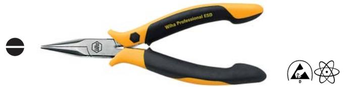
**Z 36 04** DIN ISO9655に従ったESD精密ニードルノーズプライヤー。ストレート形状で、抓み部はギザ付。C45特殊工具鋼製、焼入れ、焼戻し処理をしています。精密部品を掴んだり、曲げたりするのに使います。
