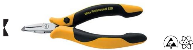
**Z 46 04** DIN ISO9654に従った40°傾斜のESD精密オブリケニッパー。先端は極細になっていて40°の傾斜が付いているフラッシュ刃。特に手の届きにくい狭い場所で威力を発揮します。軟線用。切刃硬度HRC64程度。
