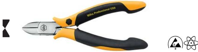
**Z 44 04** DIN ISO9654に従ったセミサーキュラーヘッドのESD精密ニッパー。先端の広いベベル刃なので硬線にも適します。切刃はHRC64程度まで高周波焼入れされ長寿命です。様々な硬度のワイヤーを切断できる万能タイプのニッパーです。
