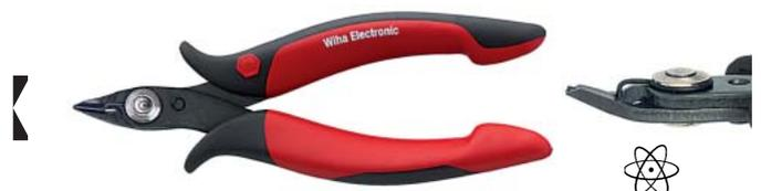
**Z 40 03** 先鋭ヘッドのエレクトロニクス用ワイヤートラップ付精密ニッパー。フルフラッシュ刃。軟線を完全に切断跡を残さずに切断できます。切断したワイヤーを落とさないワイヤートラップ付。ESD用ではありません。
