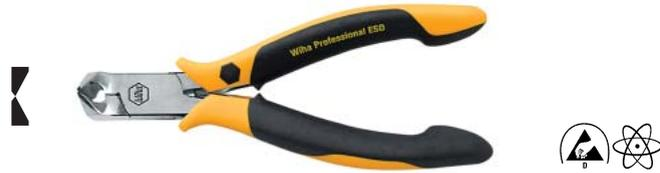
**Z 46 04** DIN ISO9654に従った29°傾斜のESD精密ニッパー。先端の広いフラッシュ刃。切刃は29°の傾斜がありますので、縦にも横にも使用できます。銅線のフラッシュカット用。切刃はHRC64程度に高周波焼入れされています。
