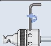
超硬カッターは付属の2mm六角レンチを使用して取り付けます
