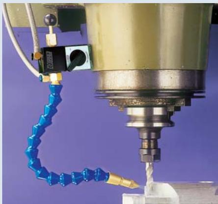
ノガ・ミニクールはベンチュリ原理を応用したもので、コンプレッサーエアさえあれば容易に、エアースプレー状の切削液の吹き付けができます。エアースプレーホースをエアースourceに、サイフォンラインを冷却液容器に差し込み、マグネット で本体を機械に固定し、ノズルを工具に当てます。ノブを引いてバルブを開けると霧状の冷却液が勢いよく噴出します。コントロールバルブで空気量を、ノズルで冷却液の吹付量をそれぞれ調整できます。
