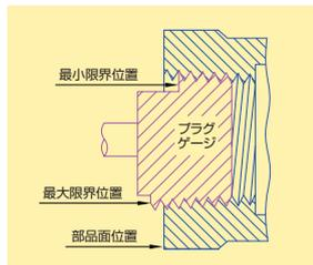
管又は管継手の末端がゲージの最大限界位置と最小限界位置を示す切り欠けの範囲内であれば合格です
