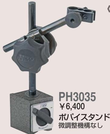
★PH3035の強力ポパイマグネットの底面は150°にV型加工されていますので、平面だけでなく円筒面にも付けられます。
