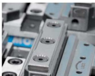
インサート式口金は両側が使用できるので自在なクランピングができます
