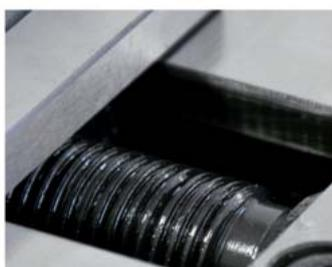
クランピングねじの設計により通常のバイスより、より強力なクランプ力があります
